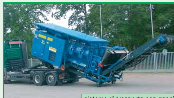
sistema di trasporto con gancio di sollevamento per versione scarrabile
