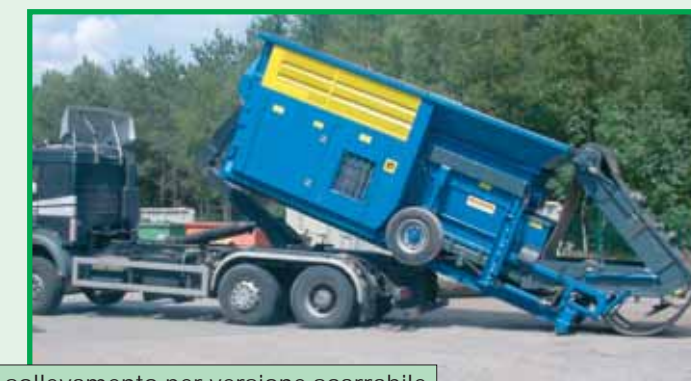
sistema di trasporto con gancio di sollevamento per versione scarrabile
